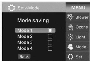
Панель управления имеет четыре различных режима. Они могут быть сохранены и выбраны с помощью навигационных клавиш.
