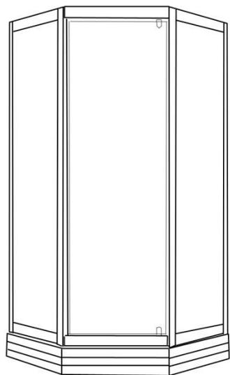
**VI, Установите задние стенки на поддон и закрепите их с фронтальной частью.**
