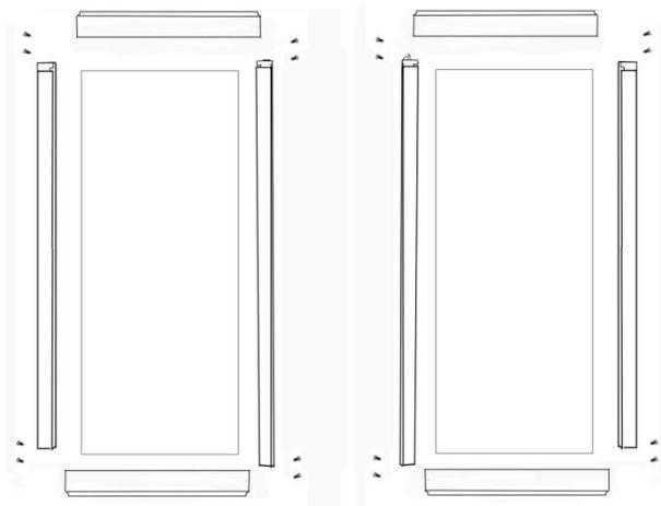
**III, Установит и закрепите лицевые профили с помощью соединительного элемента.**
