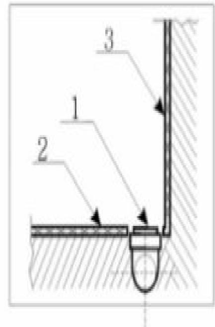
**Ⓐ** - Вывод канализации устраивается в уровень с полом из стены или из пола под срез кафельной плитки.
