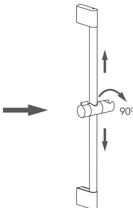
Держатель ручного душа можно перемещать вверх и вниз и изменять угол наклона в пределах 90°. Держатель надежно фиксируется на штанге с помощью поворотной рукоятки.
