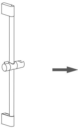
3. Вставьте в просверленные отверстия. Расположите штангу в месте установки и закрепите с помощью саморезов. Места крепления закройте заглушками.
