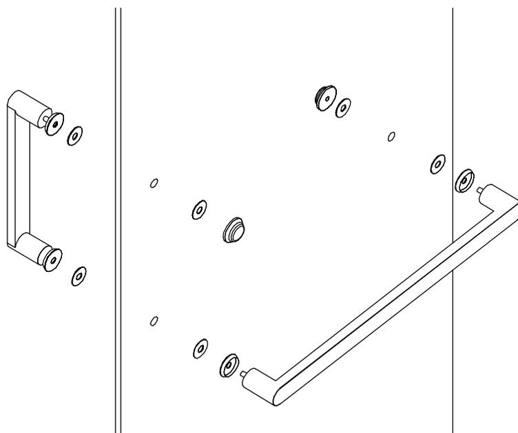
10. Отрегулируйте при помощи винтов (14) положение дверцы, после чего затяните винты. Установите заглушки (16) на шляпки винтов (13), заглушки (17) на шляпки винтов петель. Установите все уплотнители душевой кабины.
