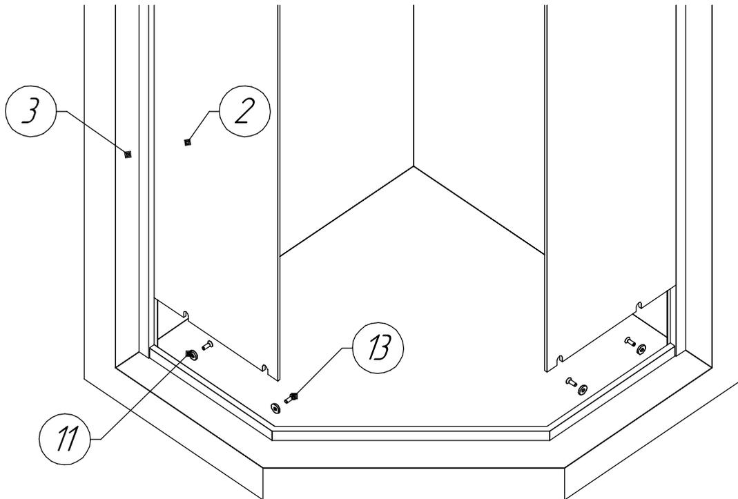
5. Вставьте верхнюю трапецию(4) в пазы пристенных профилей. Закрепите стекло к трапеции при помощи шайб(11) и винтов(13).
