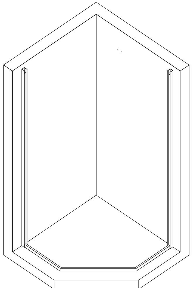
4. Вставьте боковое(2) стекло в паз пристенного профиля(3) и при помощи шайб(11) и винтов(13) закрепите стекло к трапеции(4). Прделайте аналогичные действия со вторым боковым стеклом.
