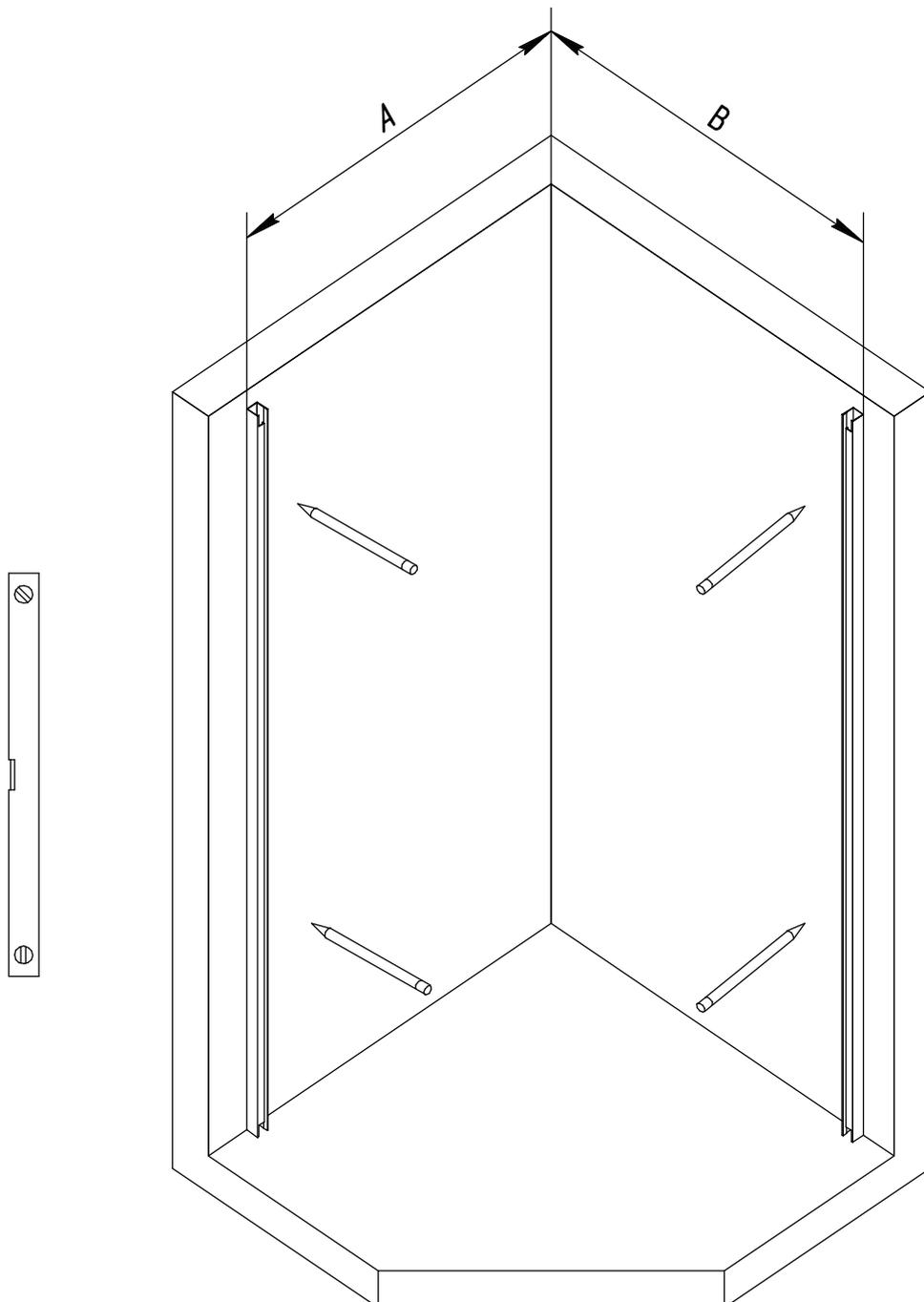
2. Отметьте при помощи рулетки и карандаша расстояние А. При помощи строительного уровня, приложенного к профилю (3), и выставленному по отметке А, сделайте отметку на стене через отверстия в профиле, предназначенные для его крепления к стене.
